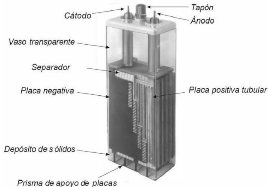
FIGURA 7.6: Batería estacionaria con desglose de elementos.
